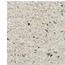
Surface sablée avec des agrégats de granit
