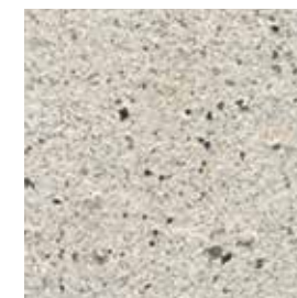
superficie sabbiata con inerti di granito
