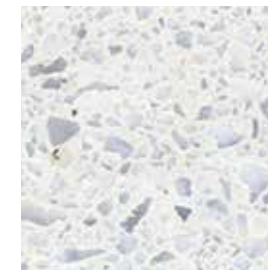
Surface polie avec des agrégats de marbre blanc
