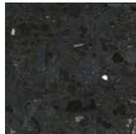
HPC con mármol negro acabado pulido
